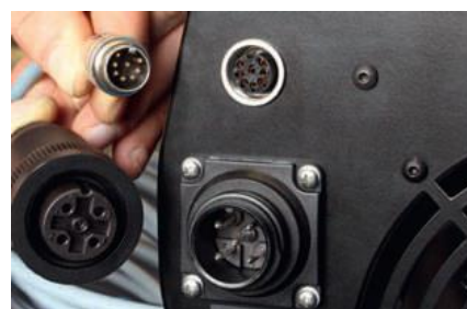
Подключение электропитания и кабеля управления
